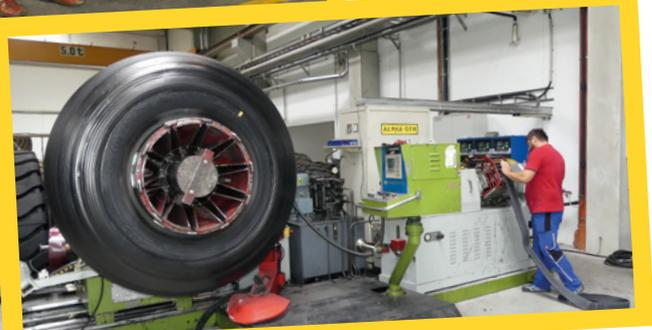
Die EM-Runderneuerung, das heißt „Großreifen für Erdbewegungsmaschinen“, kann für Reifen mit Durchmesser bis zu drei Metern durchgeführt werden. Die EM-Reifen werden von Jürgen Leifert fachmännisch belegt
